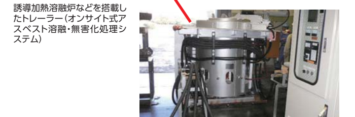
150kW誘導加熱溶融炉
