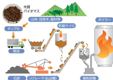
石炭火力発電所におけるバイオマス混焼発電のイメージ
