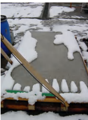
第6図 傾斜の異なる路面における融雪状況
