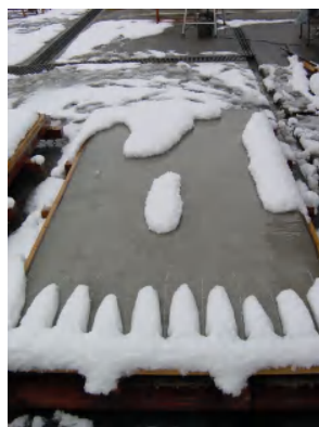
第6図 傾斜の異なる路面における融雪状況
