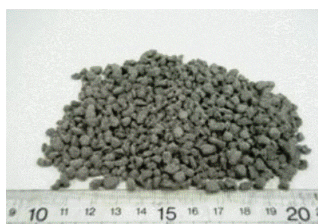
第3図 S社製セメント系固化剤を使用した造粒物 (フライアッシュA)
