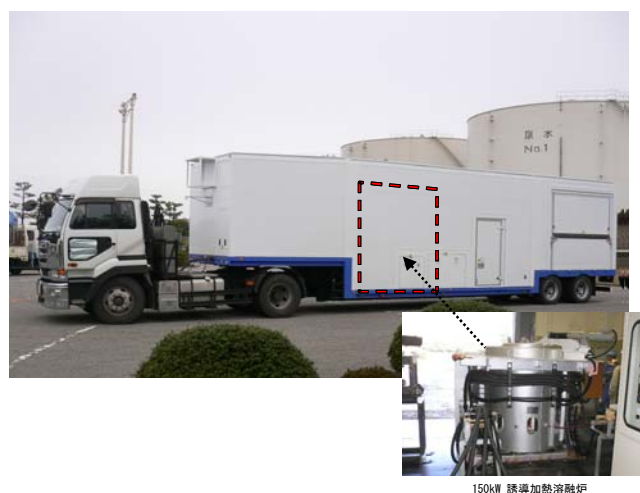
第7図 オンサイト式システム搭載図
