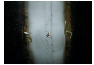
第5図 浸透深傷試験状況
