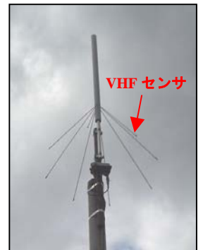
図 1 VHF 帯雷観測局の配置 写真 1 VHF センサの外観
