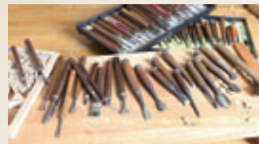
刃物が厚い荒削り用、薄い仕上げ用のノミを、細かく使い分けて制作していく
