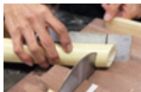
手作りの木型で各部品が同じ形になるようカット
