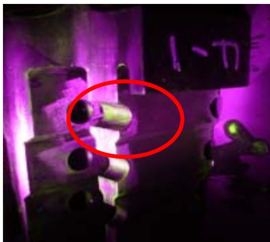
ひびの長さ : 穴の内側約 9mm、側面側約 3mm
