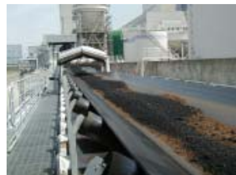
敦賀火力発電所での木質バイオマス混合燃料(石炭・木質バイオマス)の搬送
