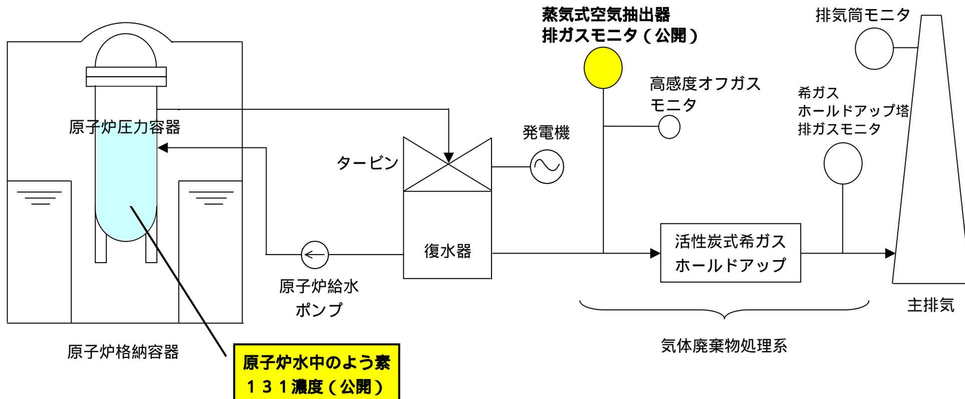
公開データ概要図 (志賀原子力発電所2号機の場合)
