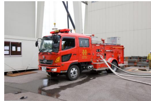
②④-1注水手段の強化・整備 消防車の配備 (写真は消防車による注水訓練時の様子)
