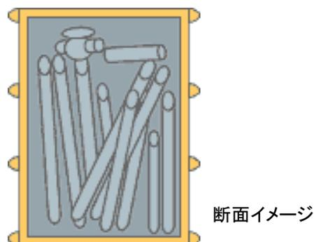
輸送する低レベル放射性廃棄物は、発電所で発生した金属やプラスチック、フィルタ類などの固体状の廃棄物を種類毎に分別し、ドラム缶に収納した後、セメント系充填材（モルタル）で固めたものです。
