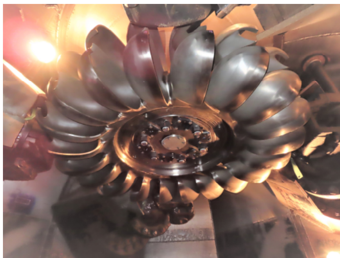
栃尾発電所 水車羽根車（ランナ）
