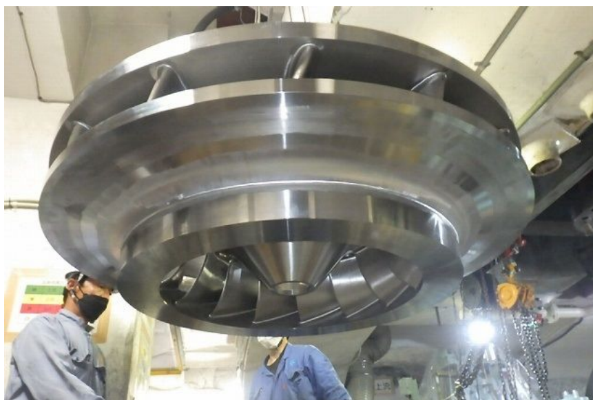
伊折発電所 水車羽根車（ランナ）
