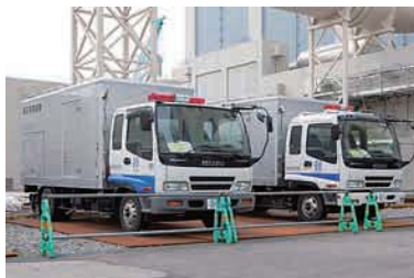
高圧電源車 [300kVA]
